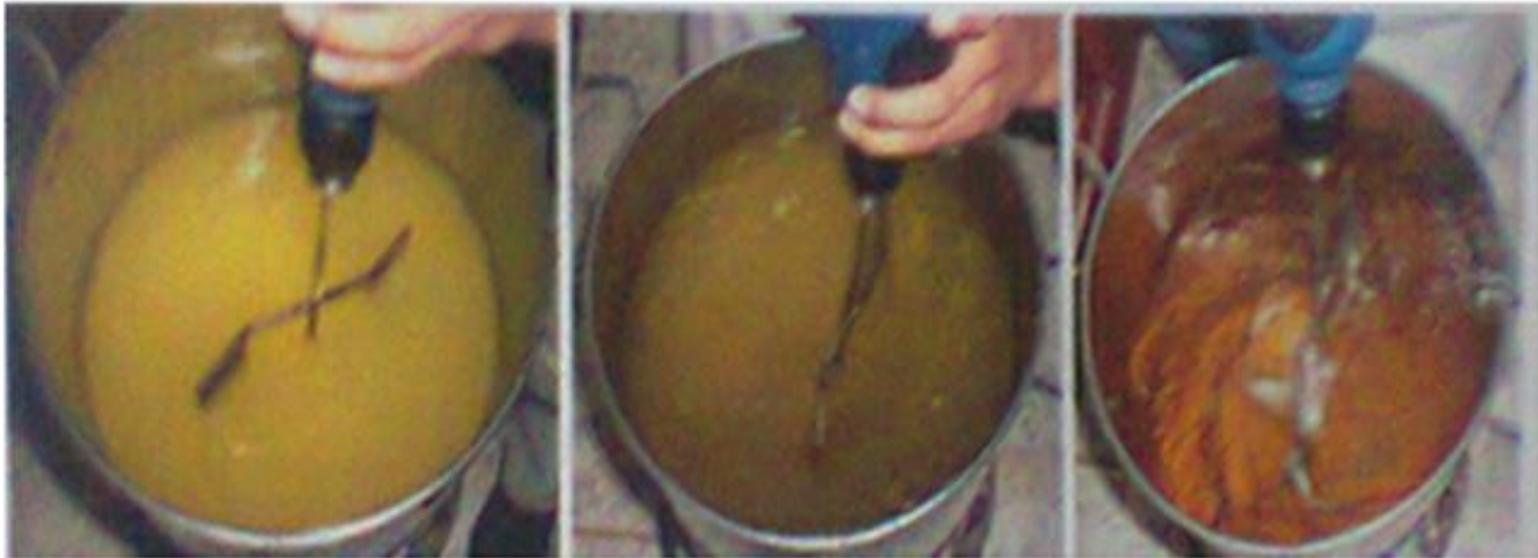
**Cambio de aspecto del biodiesel debido al calentamiento**
